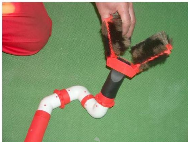
4. att Is Birste V-veida komplekt ar speci lo groz mo savienojošo elementu 2 \times 90^{\circ} un savienojošo elementu 135^{\circ} – konstrukcija at auj birstei griezties ap izolatoru
