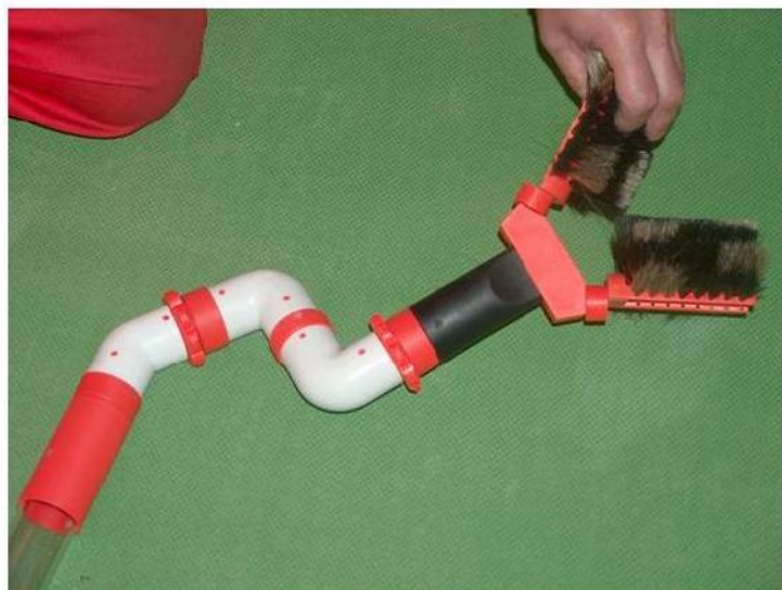
4. att Is Birste V-veida komplekt ar speci lo groz mo savienojošo elementu 2 \times 90^{\circ} un savienojošo elementu 135^{\circ} – konstrukcija at auj birstei griezties ap izolatoru
